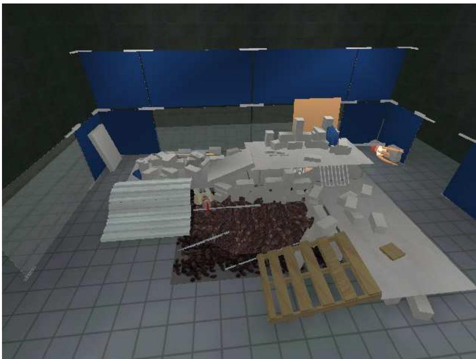
utilizzato nell'Arena Arancione), fornisce un ambiente completamente destrutturato; sono presenti cumuli di oggetti problematici quali blocchi di cemento, lastre d'acciaio, buste di plastica e tubi.
